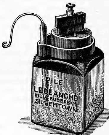
FIG. 3.—THE WET LECLANCÉ CELL.
